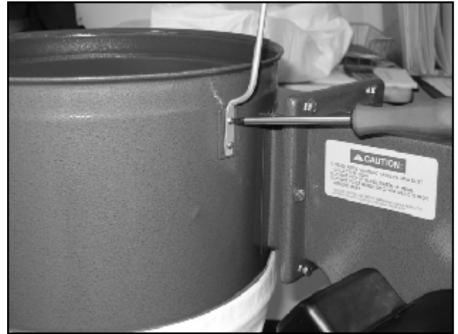
Figure 7. Installation du support de sac supérieur.
