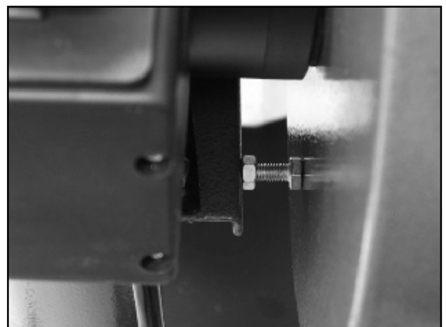
Figure 8. Réglage des boulons de la plaque de support du collecteur.
