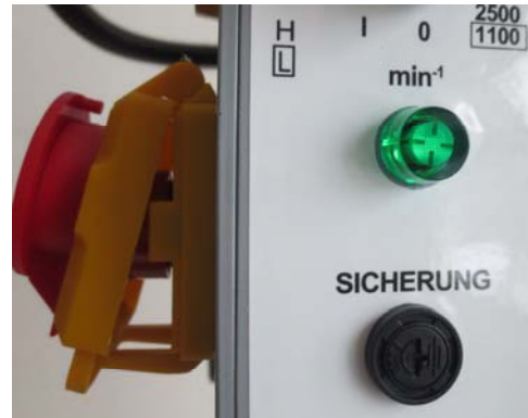
Interrupteur d'arrêt d'urgence ouvert
