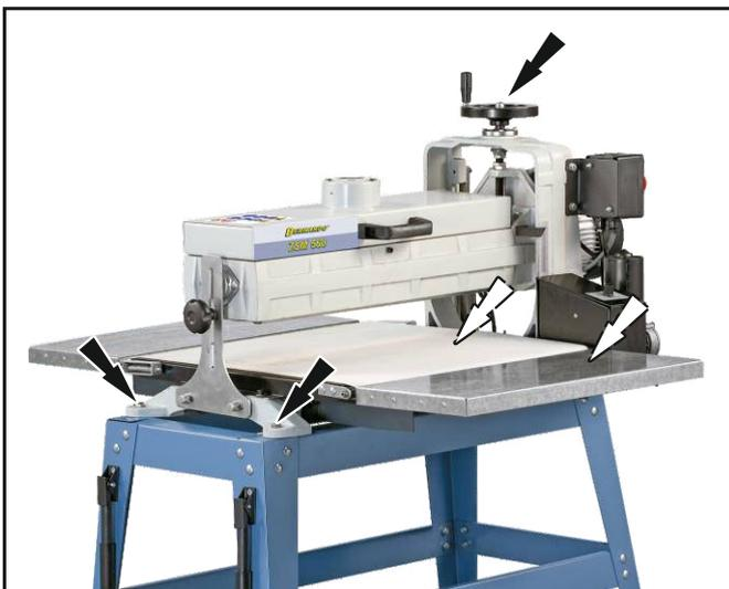
Fixez le volant à la machine à l'aide du matériel de fixation fourni. Fixez la machine à la base avec les vis fournies.
