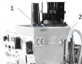
Retirer la vis 1. Faites l'appoint d'huile jusqu'à ce que le voyant d'huile soit rempli jusqu'au milieu. La tête de la machine doit être en position verticale (0°) pour cela. Reconnecter la vis 1. Vérifiez régulièrement le niveau d'huile et faites l'appoint d'huile pour engrenages si nécessaire !
