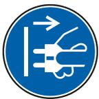
Avant de commencer tout travail d'entretien ou de réglage sur la machine, débranchez la machine de l'alimentation électrique et assurez-vous que la machine ne peut pas être mise en marche.
