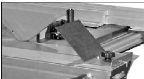
La scie TK 315 F peut être utilisée pour usiner de grands panneaux. Grâce au chariot coulissant, les grandes pièces n'ont plus besoin d'être poussées d'avant en arrière sur la table de travail.
