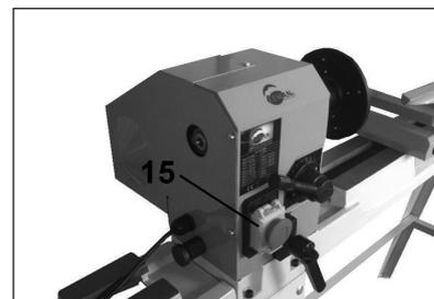
L'interrupteur marche/arrêt de la machine est équipé d'un couvercle "arrêt coup de poing" d'urgence (15). La fermeture de ce couvercle par une simple frappe provoque l'arrêt instantané de la machine.
