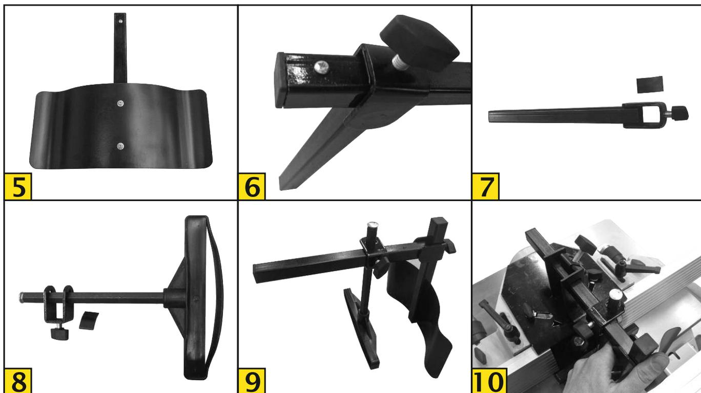
8. Montez le volant pour le réglage de la hauteur.
