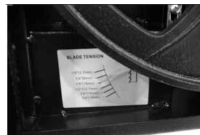
être excessive afin de ne pas provoquer la rupture de la lame: la lame doit rester légèrement souple sous la pression du doigt.
