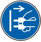
Avant de commencer tout travail d'entretien ou de réglage sur la machine, débranchez la machine de l'alimentation électrique et assurez-vous qu'elle ne peut pas être allumée.
