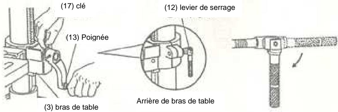
5. Assemblage de la tête (1). Placer d'abord la pièce de verrouillage (4) dans le support selon la figure ci-dessous, puis serrer les 2 leviers de serrage (12) sur le support.
