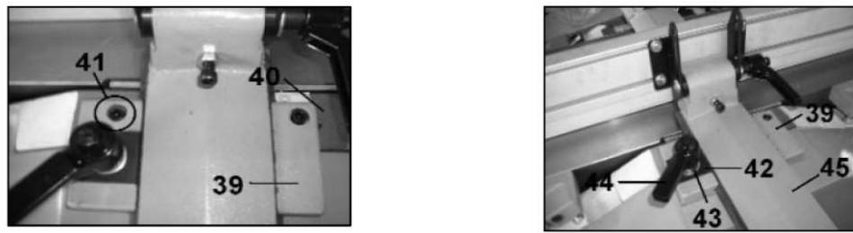
Coloque el soporte de la guía (39) en el chasis (40) de la máquina y alinear los agujeros. Fijar el soporte (39) con los 2 tornillos Allen de 6 (41).
