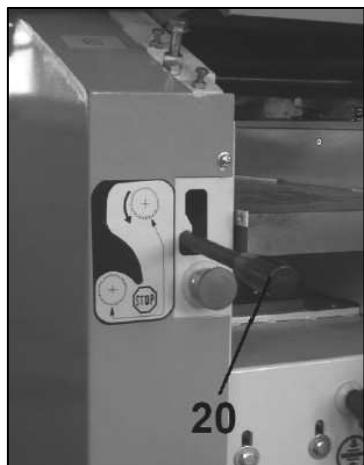
Le levier (20) placé à gauche de la table de rabotage permet à l'utilisateur de débrayer les rouleaux d'entraînement, et donc d'arrêter l'avance automatique du bois en rabotage, en cas de léger problème.
