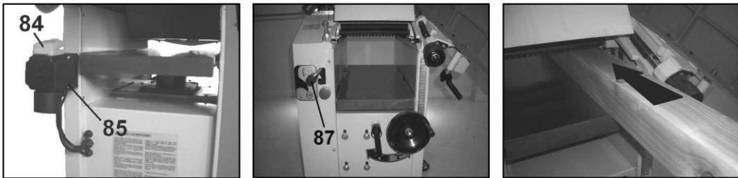
Levantar la tapa (84) del interruptor (85). Conectar la máquina pulsando el botón verde del interruptor. La parada se realiza presionando el botón rojo.
