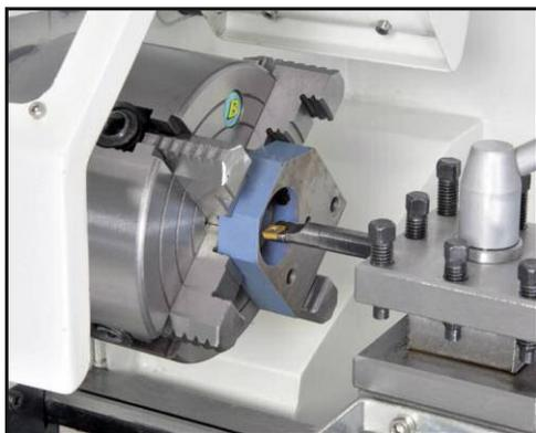
Pour une force de serrage accrue sur les pièces de forme irrégulière, une ou plusieurs mâchoires peuvent être tournées à 180° afin d'obtenir une plus grande surface de serrage.
