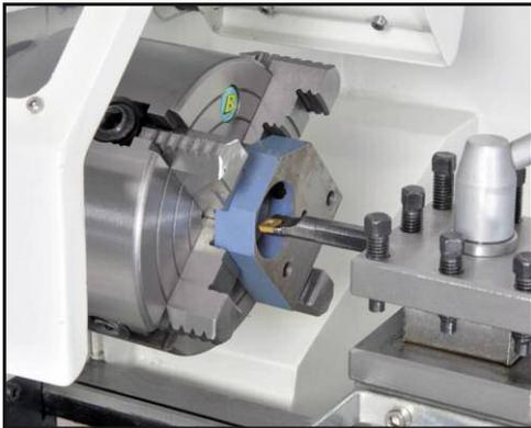
Pour une force de préhension supplémentaire pour les pièces de forme irrégulière, une ou plusieurs mâchoires peuvent être tournées à 180° afin d'obtenir une plus grande surface de serrage. Noter! Le montage du mandrin indépendant nécessite une plaque d'adaptation supplémentaire.
