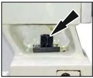
Pour maximiser la stabilité, par ex. lors d'un tournage entre deux points morts, la contre-pointe est fixée sur le bâti de la machine à l'aide d'une vis supplémentaire.
