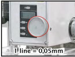
L'avance fine de la broche peut être lue sur l'anneau gradué ou sur l'affichage numérique de la profondeur de perçage.
