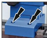
Pour augmenter la stabilité, c'est-à-dire. Lors du tournage entre pointes, la poupée mobile est fixée au banc de la machine avec une vis de serrage supplémentaire.
