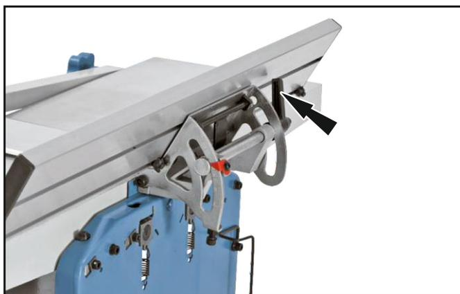
Tournez le levier pour régler l'angle du guide de rabotage. Une fois l'angle souhaité réglé, verrouillez à nouveau le levier.
