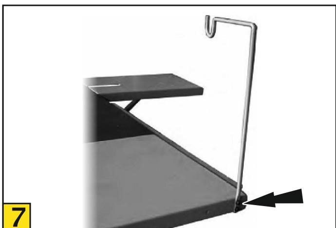
Montez le support de tuyau comme indiqué sur l'image, en utilisant 2 pièces. Vis hexagonales et rondelles M6x20.
