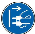
Débranchez la machine de la source d'alimentation pendant tout travail d'entretien, de réparation ou de réglage. Assurez-vous que l'interrupteur Marche/Arrêt est en position « Arrêt » avant de connecter la machine au circuit d'alimentation. Lorsque l'appareil n'est plus utilisé, débranchez la fiche d'alimentation.
