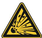
N'utilisez pas la machine dans des environnements explosifs, tels que des zones contenant des gaz, des vapeurs, de la poussière et des liquides inflammables. Les étincelles émises par la machine peuvent enflammer des gaz, des vapeurs, de la poussière ou des liquides inflammables.
