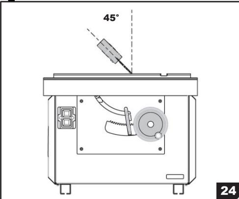
**Important :** A partir de 30° d'inclinaison, baisser la hauteur de lame de 10 mm.
