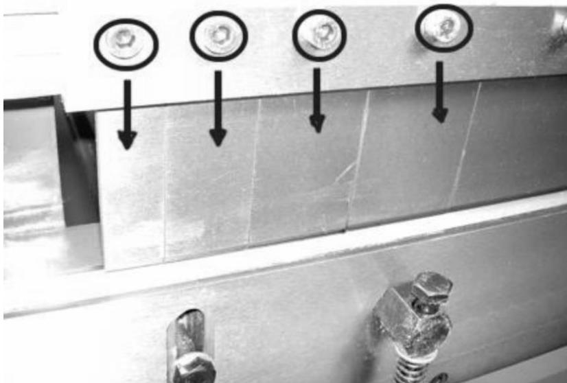
Pour la fonction de rouleuse, vous pouvez régler le rouleau arrière et le supérieur. A l'arrière de la machine vers la gauche et la droite ont chacun un bouton avec lequel la distance entre le rouleau arrière pour les deux autres - et donc le diamètre du rouleau - peut être ajustée. Si les rouleaux ne sont pas mis en parallèle, par exemple, peuvent produire des cônes.
