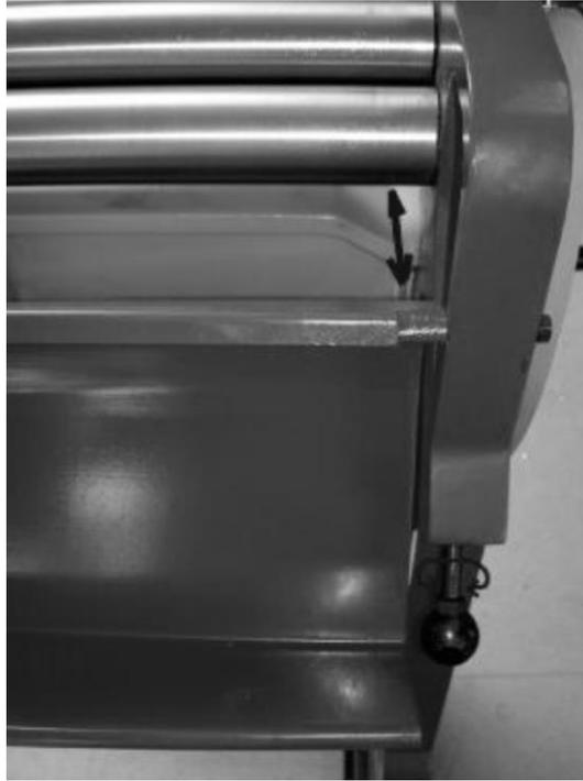
Le rouleau avant supérieur peut être tourné de 90° grâce à la vis à ailettes, sont prises unilatéralement, si nécessaire, pour éliminer les pièces circulaire fermés. En outre, les boulons sur les deux côtés, servent à fixer la base du rouleau supérieur en dehors.
