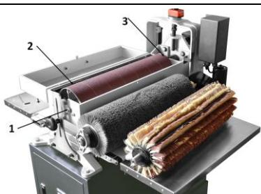
Ouvrir d'abord le cache du cylindre de ponçage qui est fixé au moyen d'une vis.
