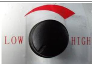
Der Vorschub lässt sich stufenlos innerhalb der angegeben Grenzen mittels dem Potentiometer, das sich unterhalb des Ein-/Ausschalters befindet, einstellen.
