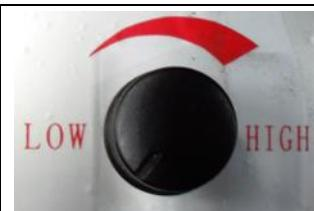
L'avance peut être réglée en continu au sein des limites indiquées au moyen du potentiomètre situé en-dessous de l'interrupteur marche/arrêt.
