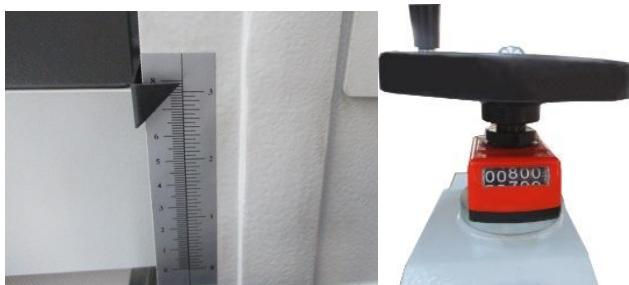
Use la manija para regular la altura. Puede leer la altura en el lateral izquierdo, en la escala o en el contador de la manivela.
