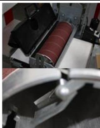
Öffnen Sie zuerst die Schleifzylinderabdeckung, die mit einer Schraube befestigt ist.
