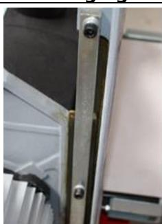
Régler la totalité des six vis de telle manière qu'elles soient parfaitement ajustées, tout en permettant de régler facilement la hauteur à l'aide de la manivelle.
