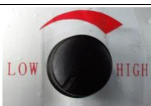
El avance se puede configurar sin fases, dentro de los límites indicados, con el potenciómetro que se encuentra debajo del interruptor de encendido/apagado.
