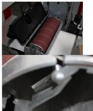
Abra, en primer lugar, la cubierta del cilindro de lijado que está sujetada con un tornillo. Puede soltar el extremo de la cinta abrasiva con la palanca de fijación de ambos lados y sacar así todo el cilindro. También puede soltar el otro extremo de la cinta abrasiva con esa palanca.
