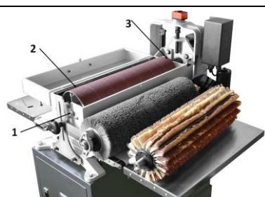
Abra, en primer lugar, la cubierta del cilindro de lijado que está sujetada con un tornillo. Retire las dos sujeciones (1) y (3) del rodillo de lijado y de la cubierta (2). A continuación, puede retirar el rodillo de lijado y colocar uno nuevo. Móntelo en el orden inverso.
