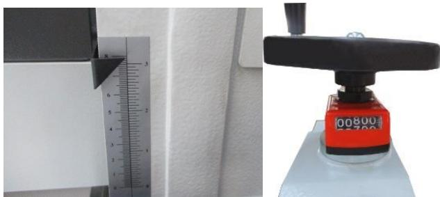
Verwenden Sie den Handgriff zur Höheneinstellung. Die Höhe können Sie auf der linken Seite auf der Skala bzw. am Zählwerk der Handkurbel ablesen.
