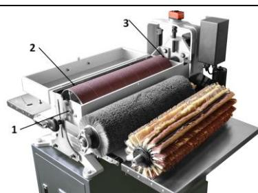
Öffnen Sie zuerst die Schleifzylinderabdeckung, die mit einer Schraube befestigt ist.
