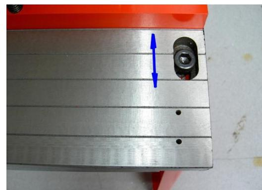
Bei der Abkantfunktion können je nach Werkstückgröße die verschiedenen breiten Segmente herausgenommen bzw. ausgetauscht werden, sodass eine definierte Biegekante erzeugt werden kann. Hierzu muss lediglich die Schraube des entsprechenden Segmentes gelöst werden, um dieses zu verschieben bzw. herausnehmen zu können.
