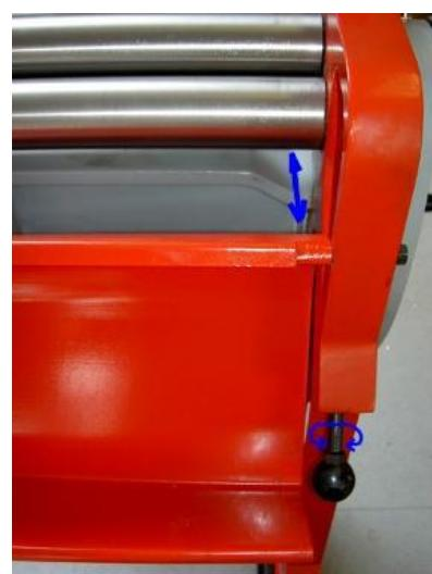
Le rouleau supérieur avant peut être retiré d'un côté en tournant la vis à oreilles de 90°, afin de pouvoir éventuellement retirer des pièces circulaires fermées. En outre, il faut dévisser les vis de maintien disposées de part et d'autre, qui servent à la fixation sûre du rouleau supérieur.
