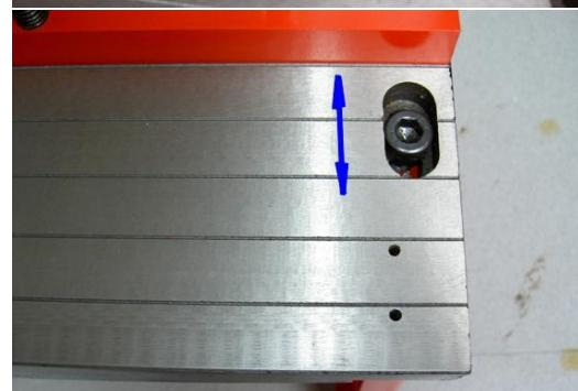
Pour la fonction de pliage, les segments de différentes largeurs peuvent être retirés ou échangés en fonction de la taille de la pièce, ce qui permet de créer une arête de pliage définie. Pour ce faire, il suffit de desserrer la vis du segment correspondant pour pouvoir le déplacer ou le retirer.
