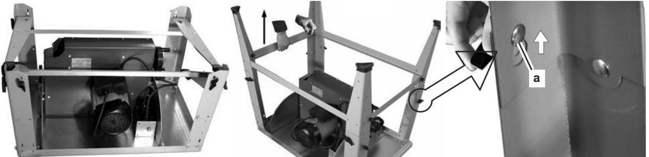
Fixez-les en place avec des vis à oreilles. Assurez-vous que le boulon est correctement installé a.
