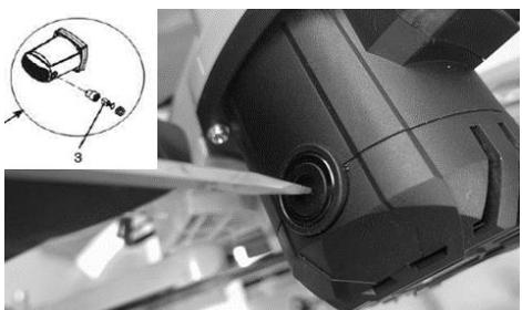
Uhlíkové kartáče zkontrolujte po prvních 50 hodinách provozu na novém stroji nebo po instalaci nových kartáčů. Po provedení první kontroly opakujte kontrolu každých 10 provozních hodin. Pokud je uhlík opotřebovaný na délku 6 mm, nebo pokud je pružina nebo trolejový drát spálený nebo poškozený, je nutné vyměnit oba kartáče. Pokud se kartáče po odstranění ukáží jako použitelné, je možné je znova namontovat.
