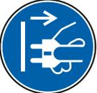
Avant de commencer tout travail d'entretien ou de réglage sur la machine, débranchez la machine de l'alimentation électrique et assurez-vous que la machine ne peut pas être allumée.
