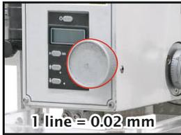
L'avance fine de la broche peut être lue sur la bague graduée ou sur l'affichage numérique de la profondeur de perçage.
