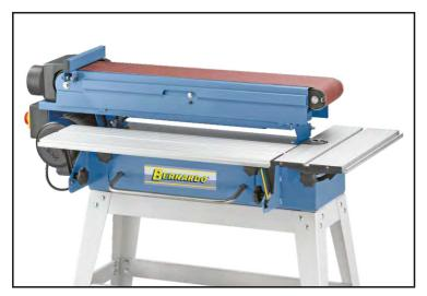
L'unité de ponçage peut être changée à 90° de la verticale à l'horizontale. Amener la table de ponçage et la table supplémentaire en position horizontale, aussi bas que possible. Desserrez le levier de verrouillage à l'arrière de la machine. Placer l'unité de ponçage dans la position requise
