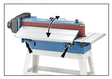
Les deux tables peuvent être modifiées indépendamment à 45°. Desserrez les vis de serrage sur le dessous de la table, réglez l'angle requis et fixez les vis de blocage. Le réglage peut être lu sur l'échelle d'angle sur le côté gauche de la console.
