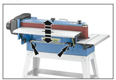
La table peut être réglée en hauteur. Desserrez les deux boutons en forme d'étoile sur le dessous de la table de ponçage pour amener la table dans la position requise et fixez-la.
