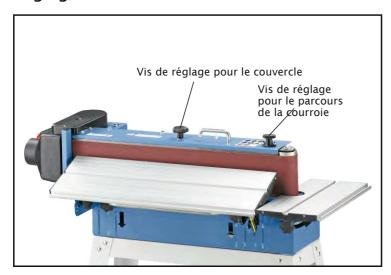
Le réglage du parcours de la bande (position de la bande abrasive sur le support de bande) se fait en tournant la vis de réglage.
