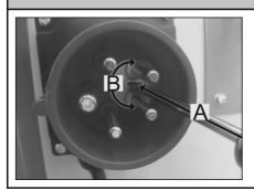
Si la rotation de la machine est incorrecte, l'inverseur de phase intégré sur la prise peut être utilisé pour la changer. (400 V) Procédez comme suit:
