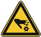
**Avertissement! Bords tranchants sur les outils !** Ne retirez jamais les copeaux à main nue. Il y a un risque élevé de blessure. Lorsque la machine est éteinte, utilisez une brosse ou un balai pour enlever les copeaux. N'utilisez jamais d'air comprimé pour le nettoyage !
