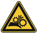
**Avertissement! Pièces tournantes.** Assurez-vous de ne toucher en aucun cas les pièces en rotation ou les pièces de la machine et assurez-vous que les bijoux et les vêtements ne sont pas aspirés par les pièces en rotation. Il y a un risque élevé de blessure !
