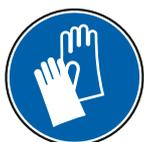
Portez des gants de protection uniquement lors du changement d'outils et lors de l'utilisation de produits de nettoyage. Lors de travaux sur des pièces en rotation, le port de gants est interdit.
