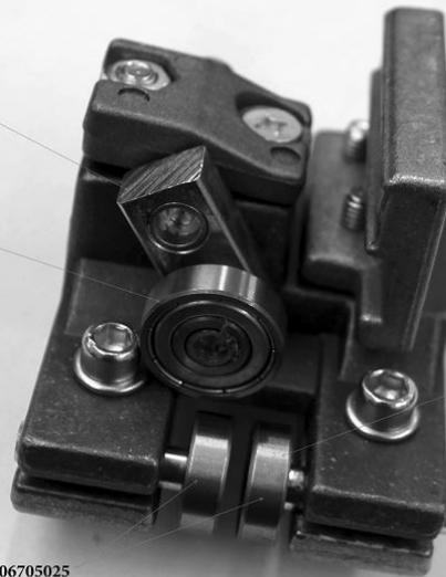
**Achtung! Sägebandführung "A" kann einzeln nicht getauscht werden, nur in Verbindung mit der Sägebandführung "B" und Führungsschiene 4901501059 Ausführung "B"**
