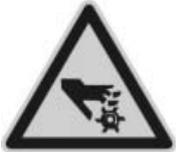
**Avertissement!** Pucés tranchantes ! Ne retirez jamais les copeaux à mains nues. Il y a un risque de blessure. Utilisez un crochet à copeaux approprié pour retirer les copeaux. Lorsque la machine est éteinte, vous pouvez enlever les copeaux avec une brosse ou un balai. N'utilisez jamais d'air comprimé pour le nettoyage !
