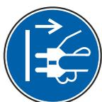
Pendant les opérations d'entretien, de transformation ou de nettoyage, débranchez la machine de la source d'alimentation. Assurez-vous que l'interrupteur marche/arrêt est réglé sur « arrêt » avant de rebrancher la machine à la source d'alimentation. Si la machine n'est plus nécessaire, débranchez-la de la source d'alimentation.
