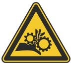
Avertissement! Pièces tournantes. Assurez-vous qu'en aucun cas l'opérateur n'entre dans les pièces en rotation ou les pièces de la machine ou que des bijoux ou des vêtements ne soient happés par les pièces en rotation. Il y a un risque élevé de blessure.
