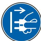
Avant de commencer tout travail d'entretien ou de réglage sur la machine, débranchez la machine de l'alimentation électrique et assurez-vous que la machine ne peut pas être allumée.
