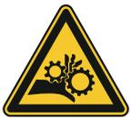
**Avertissement! Pièces tournantes.** Assurez-vous qu'en aucun cas l'opérateur ne touche les pièces en rotation ou les pièces de la machine et que des bijoux ou des vêtements ne soient happés par les pièces en rotation. Il existe un risque élevé de blessure.
