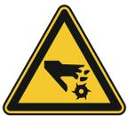
**Avertissement! Des outils pointus !** Ne retirez jamais les copeaux à la main car cela est dangereux. Lorsque la machine est éteinte, les copeaux peuvent être enlevés à l'aide d'une brosse ou d'un balai. N'utilisez jamais d'air comprimé pour le nettoyage !
