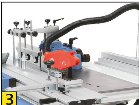
**3** Montez le couvercle de la lame de scie et le tuyau d'aspiration. Connectez le tuyau d'aspiration au système d'aspiration.
