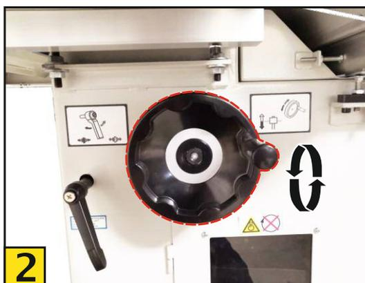
**2** Réglez la hauteur de la broche à l'aide du volant. Fixez-les avec le levier de verrouillage.
