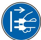
Pendant les opérations d'entretien, de conversion ou de nettoyage, débranchez la machine de la source d'alimentation. Assurez-vous que l'interrupteur Marche/Arrêt est réglé sur "Arrêt" avant de rebrancher la machine à la source d'alimentation. Si la machine n'est plus nécessaire, débranchez-la de la source d'alimentation.
