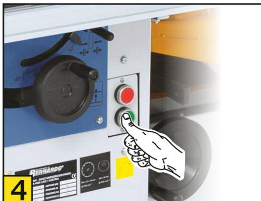
**4** Utilisez la règle de mesure pour faire glisser les butées sur les rails jusqu'à la position souhaitée et fixez-les avec les deux boutons de verrouillage sur le côté de la butée. Allumez le moteur et commencez à couper.
