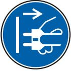
Avant de commencer des travaux de maintenance ou des réglages sur la machine, débranchez la machine de l'alimentation électrique et assurez-vous que la machine ne peut pas être mise sous tension.
