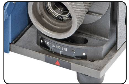
06. Sélectionnez l'angle du point (c.-à-d. 118°)
