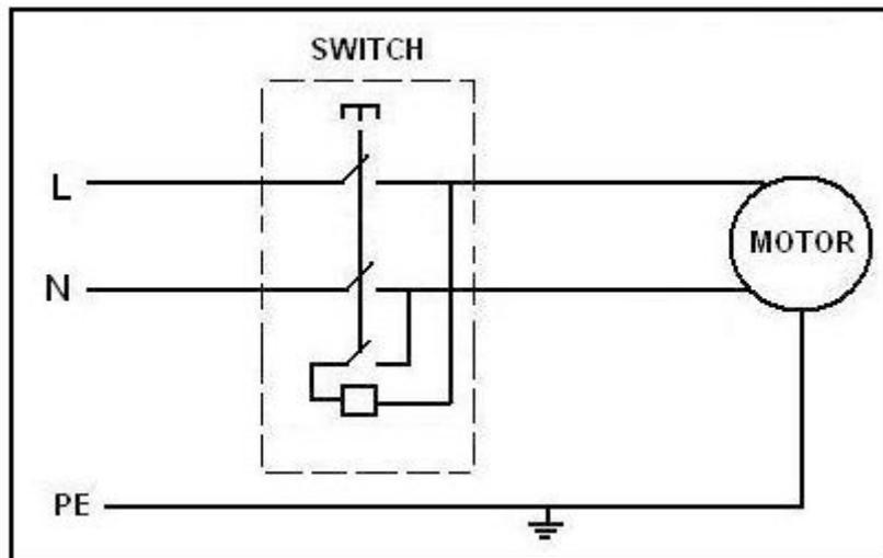
**Schéma de câblage (110V-120V/60Hz, 1 phase & 220V/60Hz, 1 phase)**
