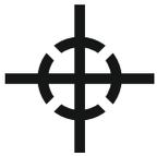
Affichez le centre de gravité sur l'emballage. Faites attention lors du levage et du transport. Le symbole n'est pas affiché sur l'emballage lorsque le centre de gravité réel est le centre. En cas de manque de clarté, contactez le fabricant.
