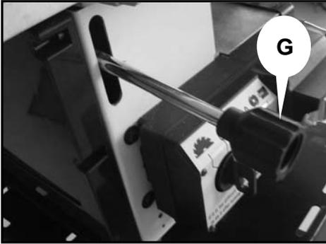
Montez ou abaissez la poignée (G) pour régler la lame de scie circulaire à la bonne hauteur, puis serrez le bouton pour verrouiller la position.
