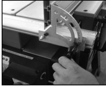
3. Assemblez le bouton et fixez l'assemblage de la table de mortaisage à la table principale, fixez-le avec le boulon à tête creuse (D). Assemblez le bras de serrage à mortaiser sur la table à mortaiser.
