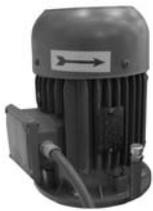
**Lors du raccordement de la machine, faire attention au bon sens de rotation du moteur - voir flèche (à 400 V)**
