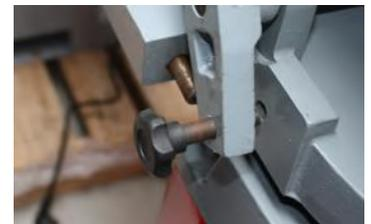
Lorsque le matériau est coupé, l'interrupteur de la BS712PRO éteint la machine automatiquement.
