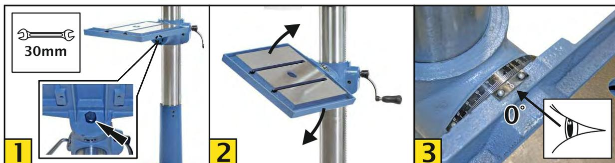
Ajuster la hauteur de la table de perçage
