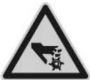
**Avertissement! Pucés tranchantes ! Ne retirez jamais les copeaux à main nue. Il y a un risque de blessure. Utilisez un crochet à copeaux approprié pour retirer les copeaux. Lorsque la machine est éteinte, vous pouvez enlever les copeaux avec une brosse ou un balai. N'utilisez jamais d'air comprimé pour le nettoyage !**
