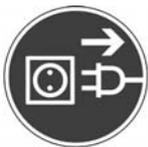
Déconnecter la machine de la machine pendant les travaux d'entretien, d'installation ou de nettoyage
