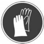
N'utilisez que des gants lors du changement d'outils de coupe. Il est interdit de porter des gants pour travailler sur des pièces rotatives de la machine.
