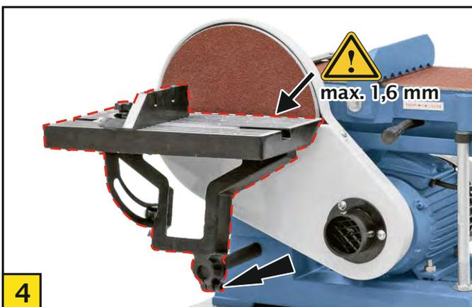
Positionnez la table de ponçage à disque et utilisez une vis Allen pour la fixer.
