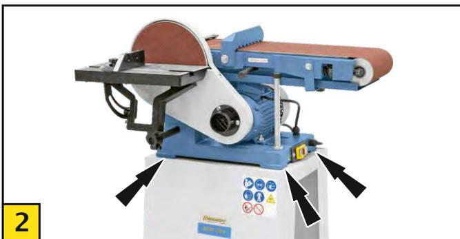
Placez la machine sur le support et utilisez des vis, des écrous et des rondelles pour la fixer.
