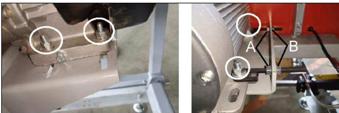
Pour changer la courroie côté transmission, desserrez les quatre boulons qui fixent le moteur à son support à l'aide d'une clé de 16 mm.
