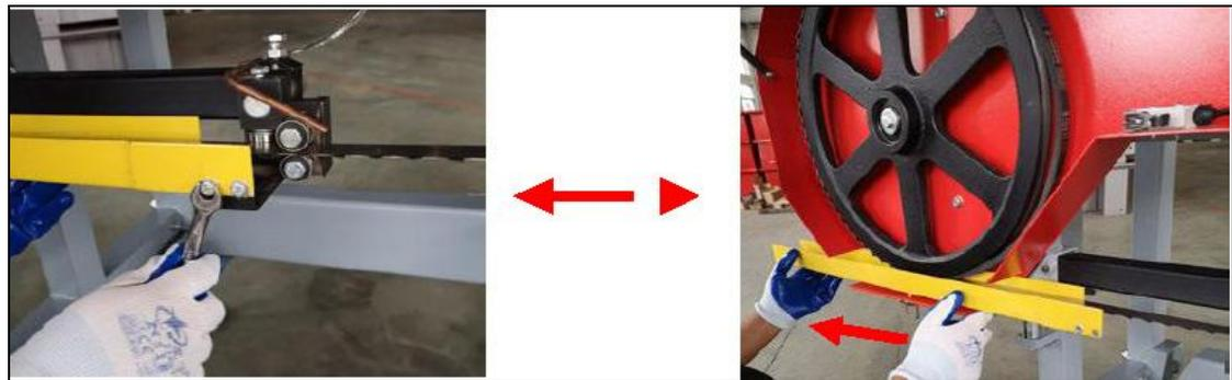
Desserrez la vis et retirez le couvercle du protège-lame.
