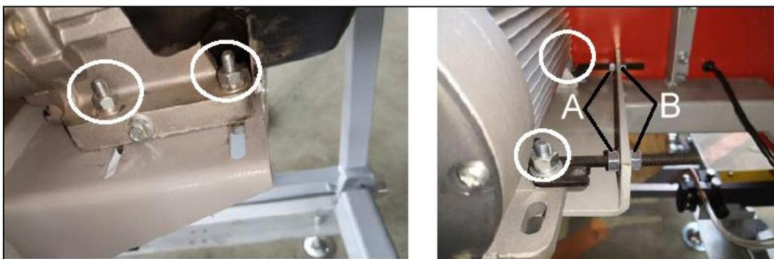
Pour changer la courroie côté transmission, desserrez les quatre boulons qui fixent le moteur au support moteur à l'aide d'une clé de 16 mm.
