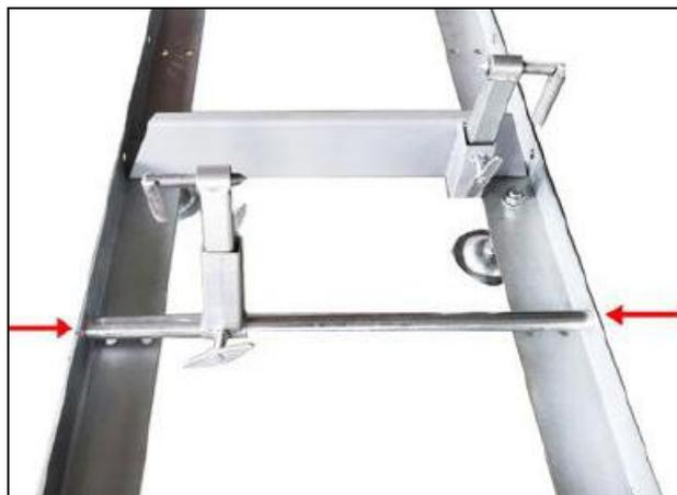
Insérez les supports de bûches dans les traverses de rail et fixez-les avec les poignées en T. Le filetage de la poignée en T doit être enduit de graisse imperméable.
