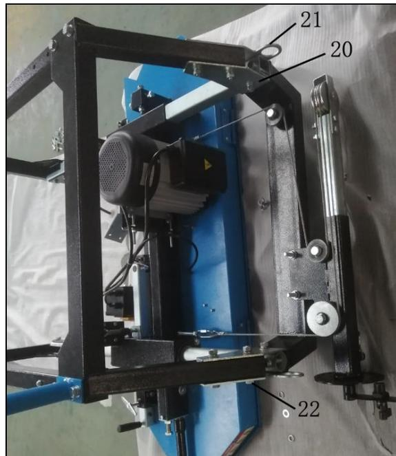
5.4.7 Desserrez les deux vis à tête cylindrique et installez l'interrupteur d'alimentation sur le cadre vertical droit. Desserrez les deux vis à tête cylindrique sur le cadre vertical gauche et fixez l'ensemble de la prise.
