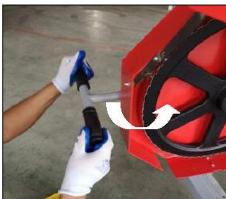
Relâchez un peu la tension de la lame en tournant la poignée en « T » dans le sens inverse des aiguilles d'une montre d'un tour complet à partir de la position de tension maximale.
