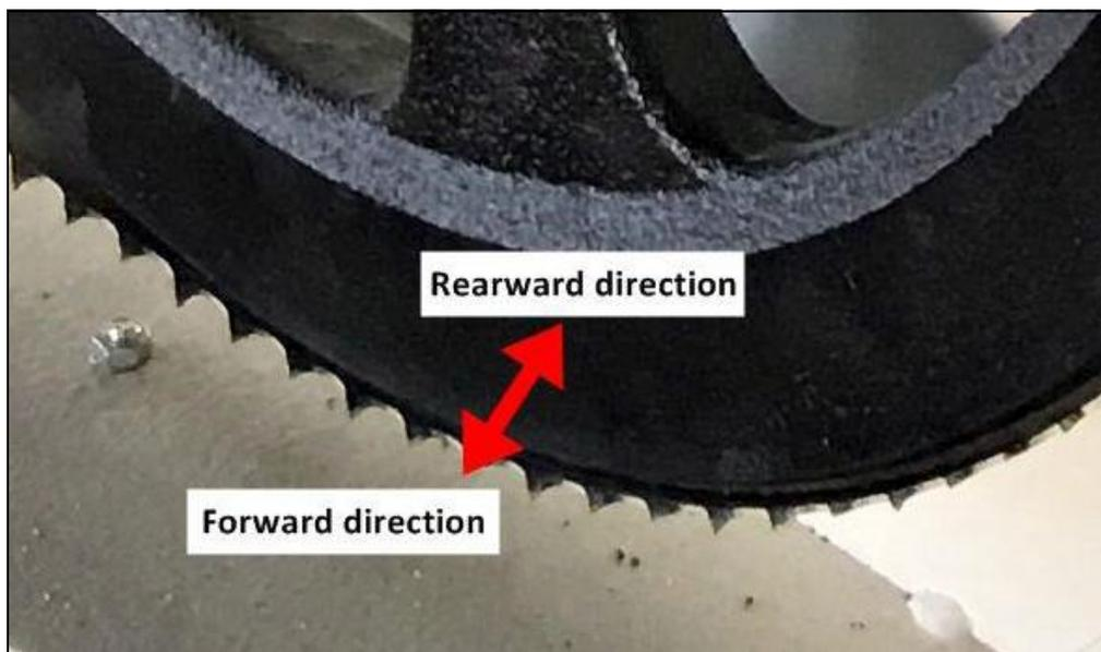
La lame doit fonctionner avec la même distance entre la dent et la face avant du volant, des deux côtés. Mesurez la distance entre la pointe de la dent et la face avant du volant, des deux côtés. Si un réglage est nécessaire, les étapes ci-dessous détaillent la procédure.
