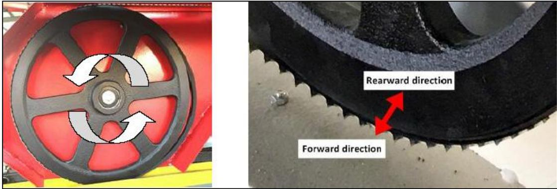
En portant des gants, faites tourner la roue à la main et observez l'évolution de la trajectoire de la lame. Mesurez à nouveau la distance et répétez l'étape précédente pour compenser davantage si nécessaire.
