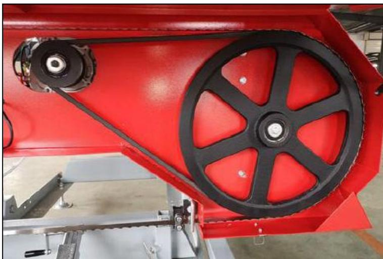
Pour vérifier la tension de la courroie, essayez de la dévier fermement de haut en bas avec votre main. La déviation ne doit pas dépasser 6 mm dans les deux sens (12 mm au total). Si la courroie fléchit davantage, elle devra être retendue comme indiqué ci-dessous.
