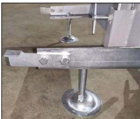
Assemblez les butées de chariot aux extrémités des rails (4 butées au total) et serrez.
