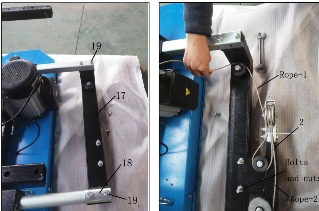
5.4.5 Desserrez l'écrou de chaîne sur la tête de la machine. Passez le câble d'acier sur la poulie. Fixez les deux extrémités du câble aux supports. Serrez l'écrou de chaîne. Actionnez la poignée de levage pour tendre le câble d'acier. Verrouillez les poignées de verrouillage.
