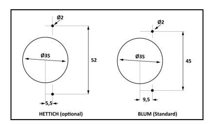
Pour passer d'un type à l'autre, l'engrenage de forage doit être changé. L'équipement de forage pour Blum est équipé de série.
