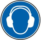
Pendant le fonctionnement, le niveau de pression acoustique peut dépasser 85 dB (A) en fonction de la pièce et/ou du matériau. Nous vous conseillons de porter une protection auditive adaptée !
