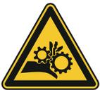
**Avertissement!** Pièces tournantes. Assurez-vous qu'en aucun cas l'opérateur n'atteint les pièces en rotation ou les pièces de la machine ou que les bijoux ou les vêtements ne soient happés par les pièces en rotation. Il y a un risque élevé de blessure.
