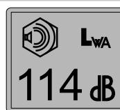
Garantiert Schallleistungspegel des Gerätes.
