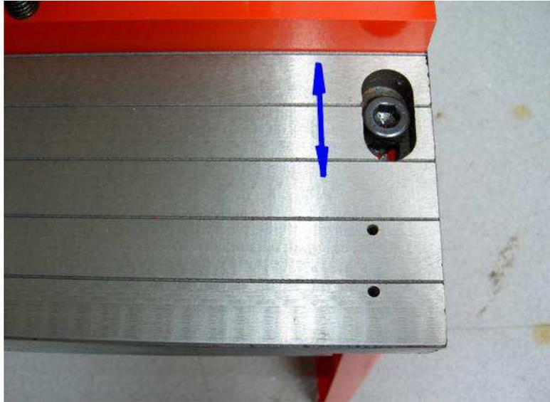
Pendant la fonction de pliage, selon taille de la pièce, les segments de différentes largeurs peuvent être enlevés ou remplacés, de sorte qu'un bord défini de flexion peut être produite. Pour cela, il suffit d'ajuster la vis du segment correspondant, à mettre en œuvre tel ou pour le retirer.
